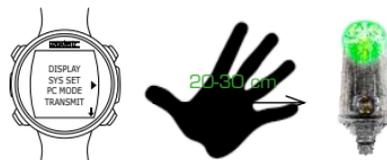
Drücken Sie den Knopf **B**, um die Suche nach dem Transmitter zu starten (SRC). Wenn die Kopplung abgeschlossen ist, wird die TX ID des Transmitters am Bildschirm angezeigt.
