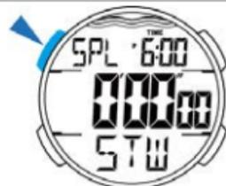
3. Обнуление и сброс производятся повторным нажатием кнопки A.
