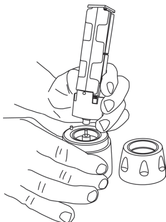
Zeichnung 8 - Richtiges Einsetzen des Batteriebehälters
