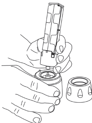
Dessin 8 - Mise en place correcte du compartiment piles
