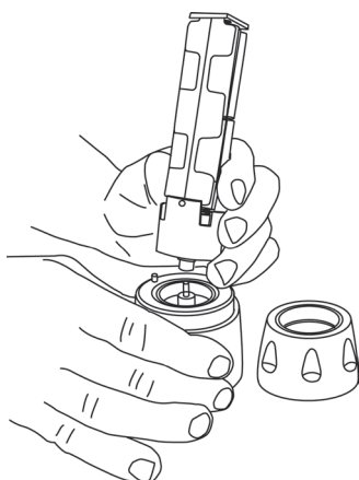
Fig. 8 - Corretto inserimento del cestello porta batterie
