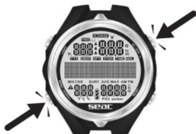
Wenn das Display ausgeschaltet ist, wird es durch gleichzeitiges Drücken der Tasten LL HR eingeschaltet.
